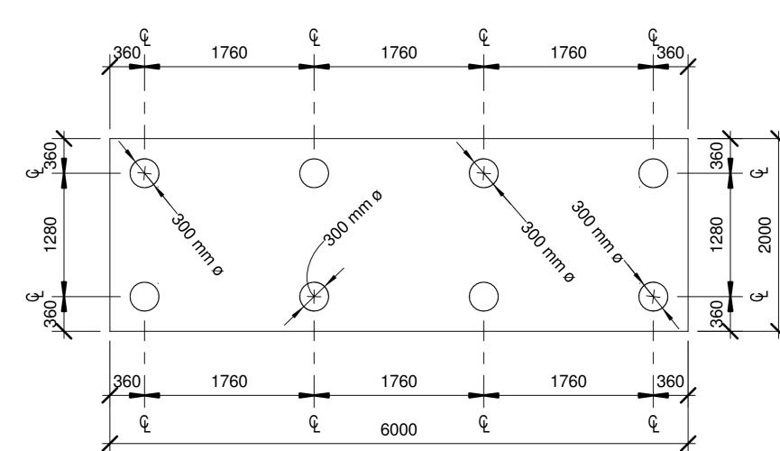
Pier Pile Layout Plan Scale: 1:50
